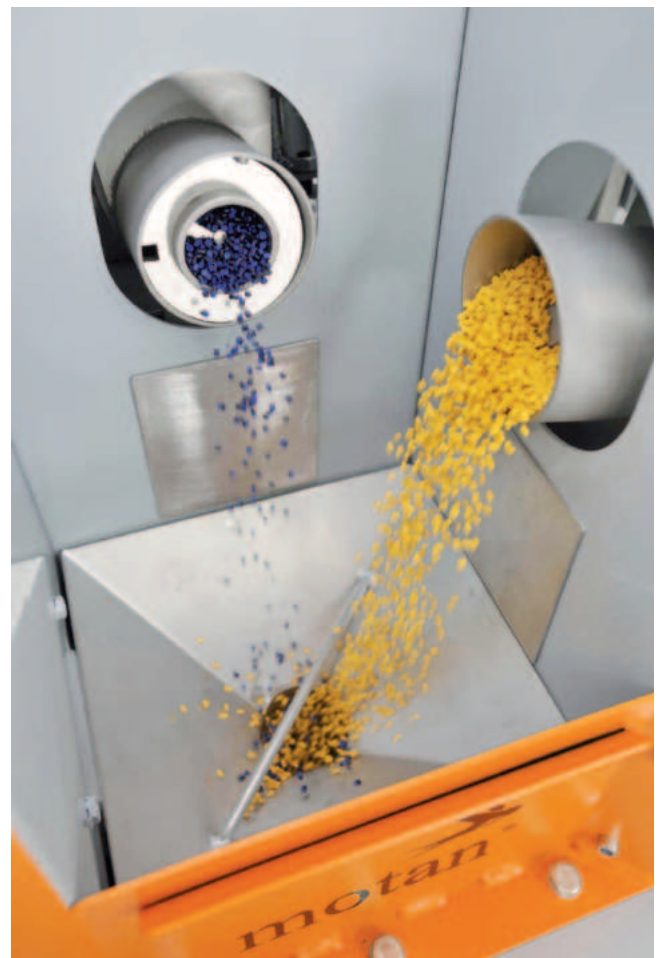
Dosierschnecken im Synchron-Dosiersystem (Alle Bilder: motan)
