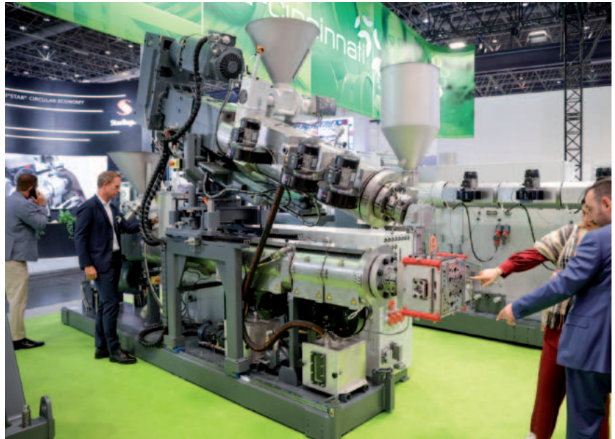
Coextrusionsanlage twinEX mit montiertem conEX und Mehrschicht-Coextrusionswerkzeug von Exelliq (Foto: Messe Düsseldorf / cillmann)
